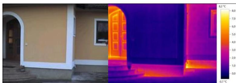
Mit der Thermogafiekamera wird ermittelt, wo die kalte Luft bei Türen oder Fenstern eindringt, welche Heizkörper nicht ihre volle Leistung erbringen oder wo es Kältebrücken gibt. Mit der Kamera werden die Quellen von Energieverlusten aufgespürt und dokumentiert. Diese Daten liefern die Basis für künftige Sanierungen.
